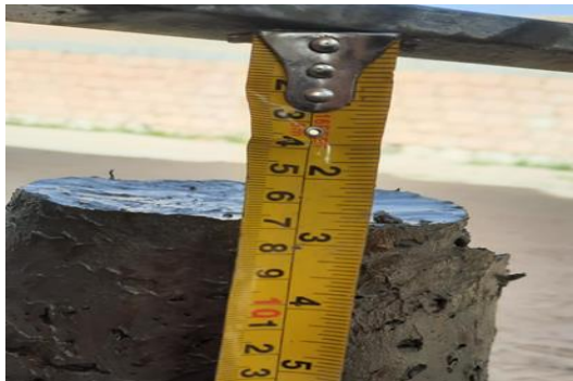
شكل 9: الهبوط للخرسانة مع 0.25 الياف فولاذ + 0.25 والياف اطارات.
