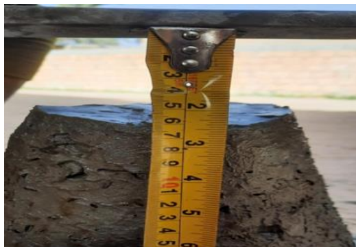
شكل 10. الهبوط للخرسانة مع 0.25 الياف فولاذ + 0.5 الياف إطارات.
