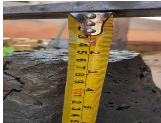
شكل 9. الهبوط للخرسانة مع 0.5الياف فولاذ + 0.25الياف اطارات.
