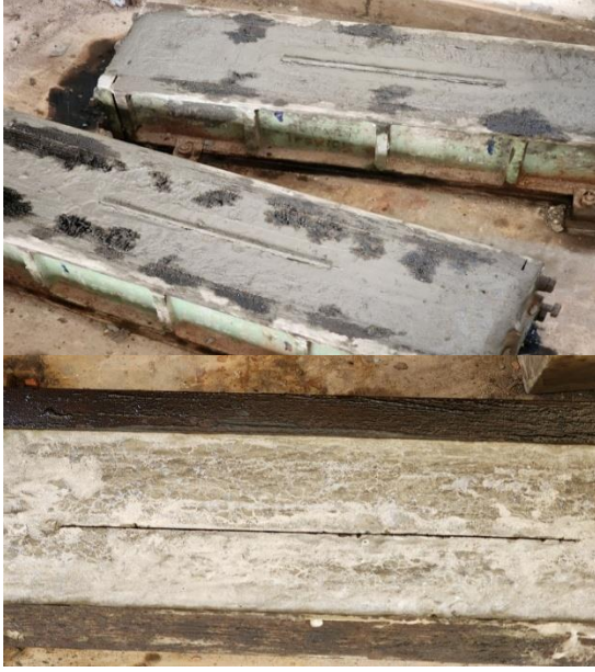
شكل 3. الشقوق الاصطناعية للعوارض الخرسانية بواسطة صفائح فولاذية.
