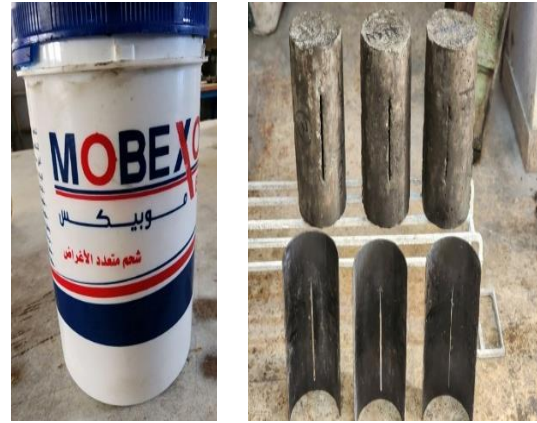
شكل 2. الشقوق الاصطناعية بواسطة الصفائح الفولاذية للأسطوانات ومادة التشحيم المستخدمة.
