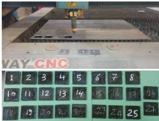
شكل 3: آلة القطع بالبلازما المسيرة بالحاسوب.
